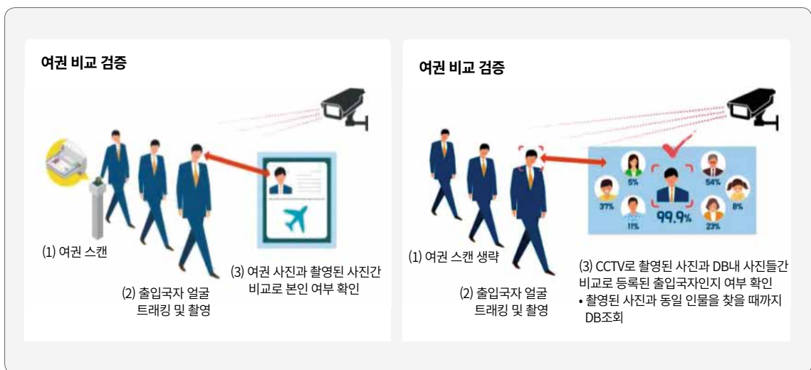
[ 그림 2 ] 식별추적 시스템 안면인식 시나리오
